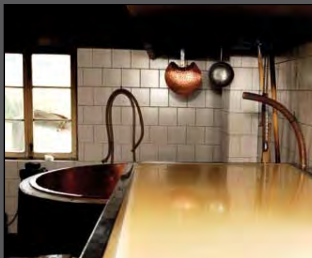
2. Vasca di affioramento in locale adatto
